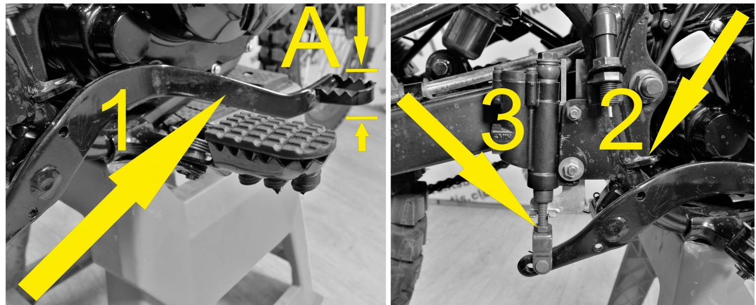
Свободный ход [A] педали заднего тормоза [1] должен быть 3-5 мм; прежде чем поршень начинает перемещение в тормозном цилиндре (**при нажатии Вы почувствуете более сильное сопротивление педали**).
