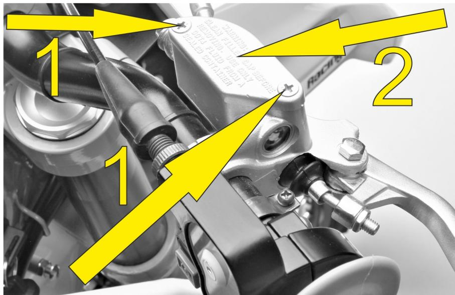
Установите тормозной цилиндр в горизонтальное положение и заполните бачок чистой тормозной жидкостью (DOT 4) до уровня (5 мм) ниже обода.
