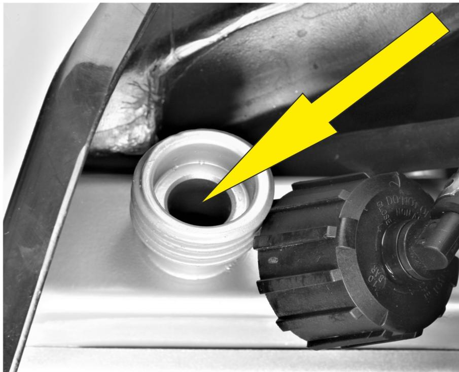
В качестве теплоносителя используется смесь; 50% антифриза и 50% дистиллированной воды. Эта смесь обеспечивает защиту от замерзания, а также хорошую защиту от коррозии.
