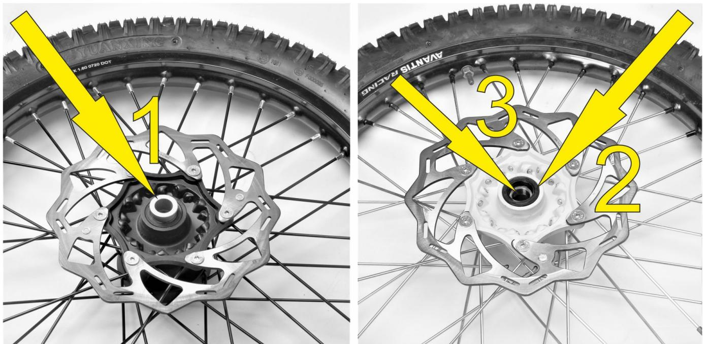
Установите переднее колесо в вилку и просуньте ось колеса [4] через зажимы и ступицу колеса.
