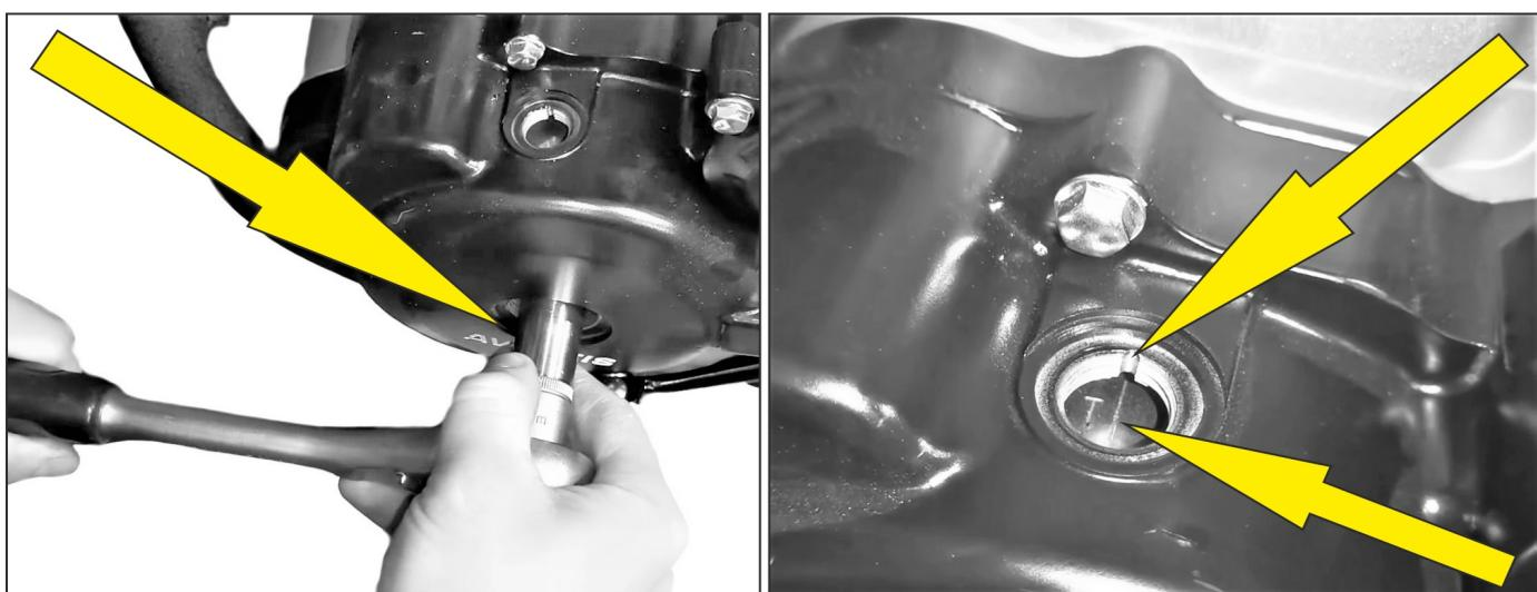
– Дополнительные метки находятся в головке цилиндра. Под крышкой (пробками) [2] на шестерне газораспределительного механизма находятся метки, которые должны совпасть аналогично нижним меткам ротора генератора.
